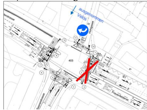
Abbildung 25: Möglicher Knotenumbau bei der LSA Nr. 403
