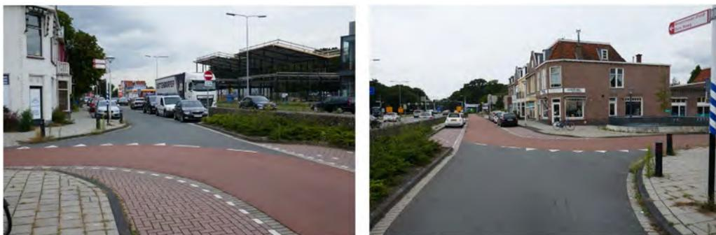
Abbildung 36: Referenzbild für Knotenlösung mit eingefärbtem Belag
