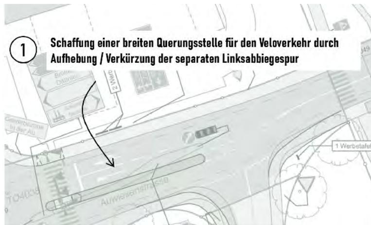
Abbildung 24: Massnahme zur Optimierung des Vorprojekts LSA Auwiesenstrasse / In der Au
