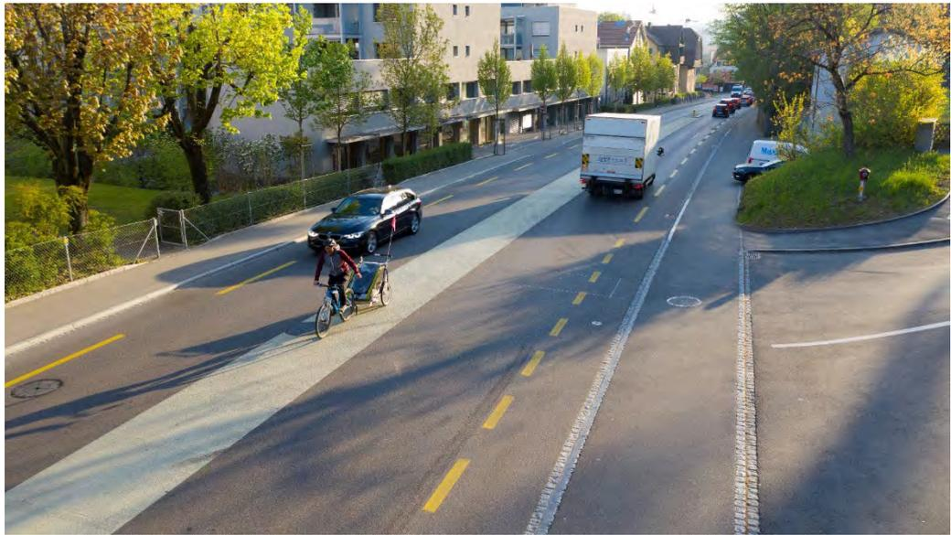
Abbildung 31: Beispielhafte Mittelzone als Abbiegehilfe
