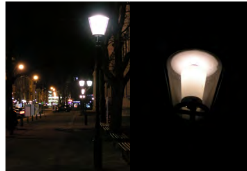
19 Stadthausstrasse: Hohe Blendung und Lichtemissionen, keine angemessene Ausleuchtung des Stadtraums (-)
