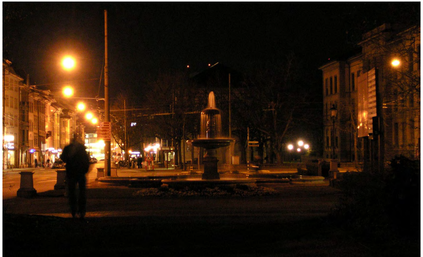
Stadthausstrasse: Die Fusswege sind diffus über die Strassenbeleuchtung mitbeleuchtet, die Randzonen für Fussgängernutzung sind nicht separat ausgeleuchtet und entsprechend dunkel (-); die Stadthausstrasse als boulevardartiger Stadtraum kann deutlich an Charakter gewinnen. Architekturen, Brunnen, Grünzonen und die Aufwertung zur Kulturachse können sie zum «Rückgrat» der Altstadt machen.
