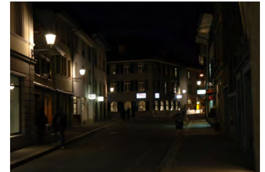
8 Tösstalstrasse, Beispiel für bestehende Grundbeleuchtung: Blendung, Lichtemission auf Fassaden, Stadtraum nachts unklar (-)
