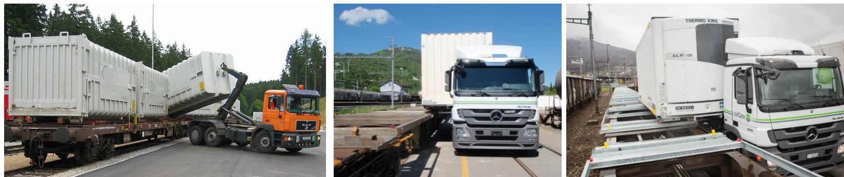
Abbildung 38 Umschlaganlage für Behälter (Kombinierter Verkehr, Horizontalumschlag) (Quelle der Abbildungen: www.wikiwand.com , www.innovatrain.ch , www.genie.ch )
