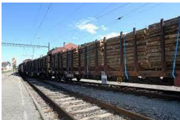
Abbildung 36 Freiverladeanlage für Langgut (Rundholz) (Quelle der Abbildung: SBB Cargo)
