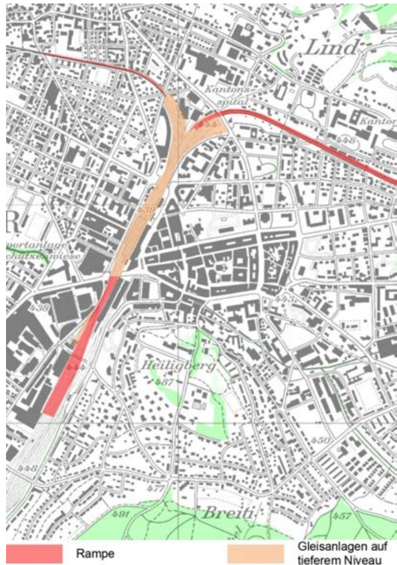
Abbildung 26: Variante Reiterbahnhof mit Auswirkungen der Tieferlegung des Gleiskörpers, Studie VOB
