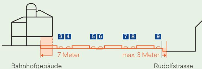
Alle sieben Durchgangsgleise werden bis zu 7 Meter in Richtung Bahnhofgebäude verschoben. Das Perron 3 wird zur Hälfte in das Bahnhofgebäude und das Stadttor integriert.
