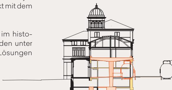
Die Westfassade des Bahnhofgebäudes wird durchgehend geöffnet und das neue Gleis wird über das Hausperron erschlossen, das im Gebäude integriert ist.
