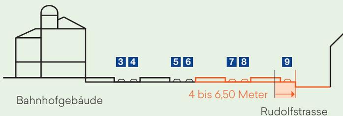
Die Durchgangsgleise 7 bis 9 werden 4 bis 6,50 Meter in Richtung Rudolfstrasse verschoben.
