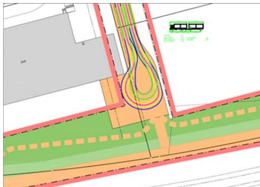
Der bestehende Kehrplatz (orange) ist in der Freiraumplanung und der Flächensicherung für eine künftige Unterführung berücksichtigt. Auch grössere Lastwagen (mit Anhängern oder Sattelschlepper) werden weiterhin wenden können.
