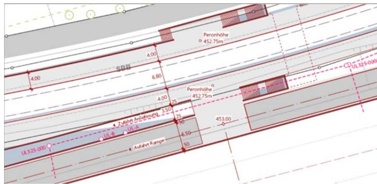
Planausschnitt mit Unterführung und Perronanschluss an der SBB-Linie nach Frauenfeld (Schlussbericht «Bahnhof Grüze - Klärung Schlüsselstellen», 29. November 2011)
