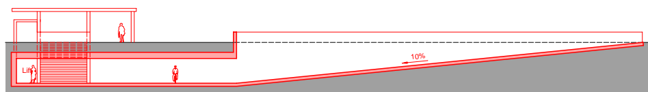
Längsschnitt Rampen Nord, 1:500
