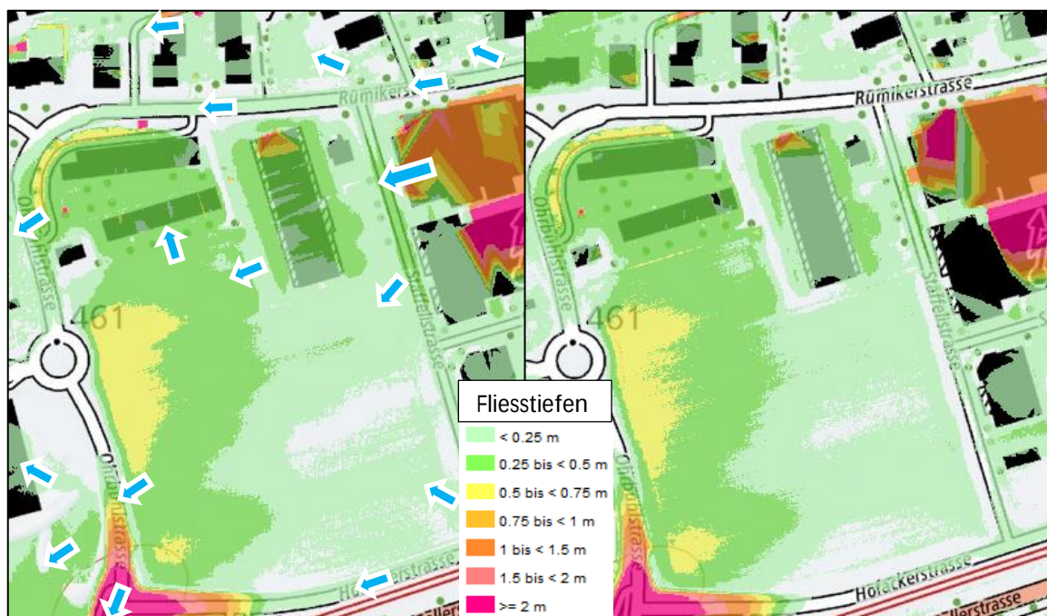
Abbildung 4: Vergleich von einem Abfluss von 9 m 3 /s mit Fließpfeilen (links) mit dem alten 2D-Modell (rechts) bei einem EHQ
