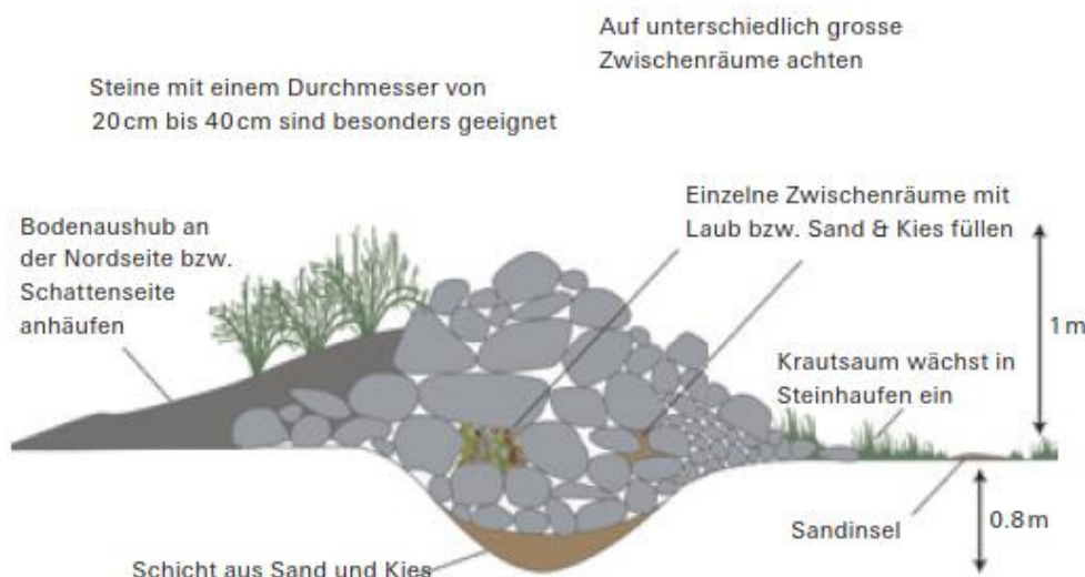
Abb. 3.5 Aufbau eines Steinhaufens (Quelle: Merkblatt Steinhaufen Kanton AG/Labiola).
