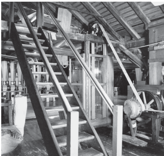
▲ Riemenantrieb des Sackliftes | Foto: H.P. Bärtschi
