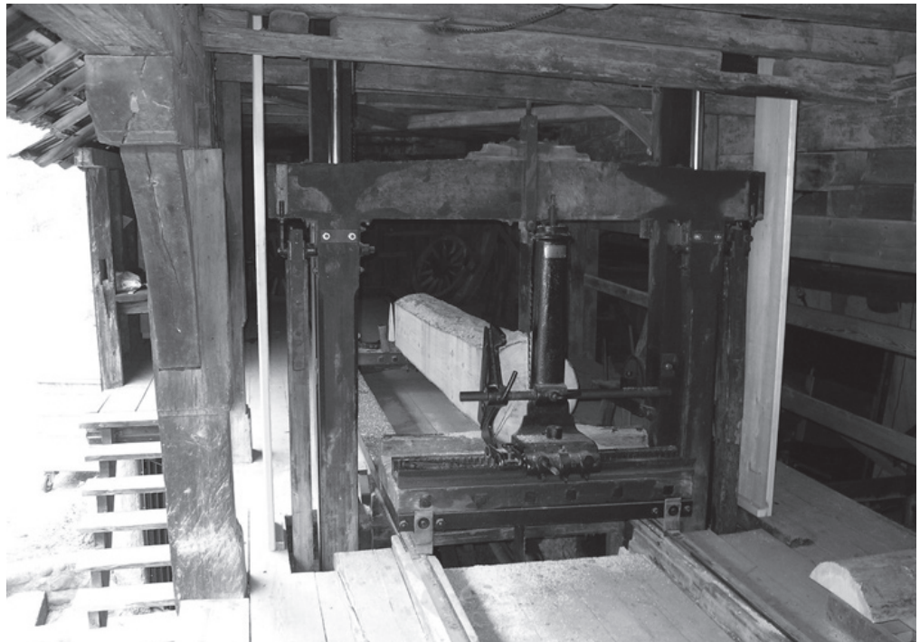
Rechts: Die heutige Einfachgattersäge in Betrieb. Foto Jürg Rohner
