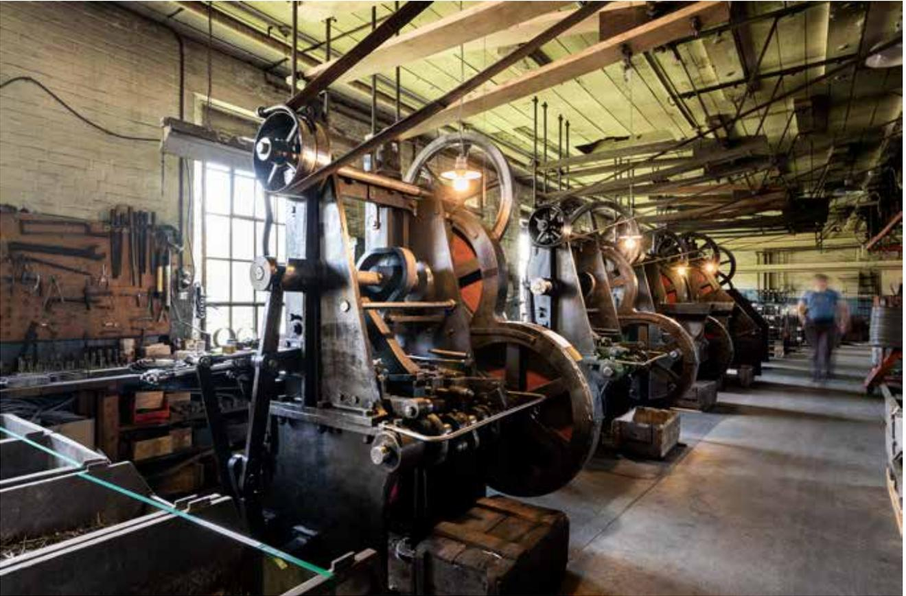
Nagelfabrik, St. Gallerstrasse 138, erbaut 1885/86, 1911 und 1954, Fabrikgebäude mit noch betriebsbereiten Drahtstiftschlagmaschinen und Transmissionssystemen
