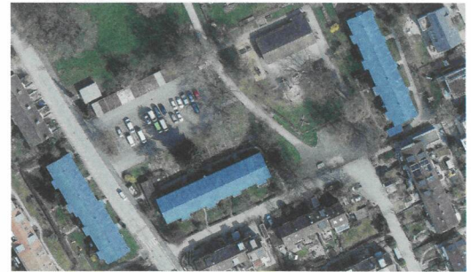
Luftbild der Siedlung Schachen als typische Siedlungsarchitektur der 1940er Jahre mit niedrigen, locker verteilten Baukörpern in Holzständerbauweise und gemauerten Brandwänden, 2021
