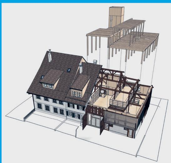
Zeichnung der zusätzlichen Tragkonstruktion (© BM+OBV Architekten, Blatter Müller + Oliv B)
