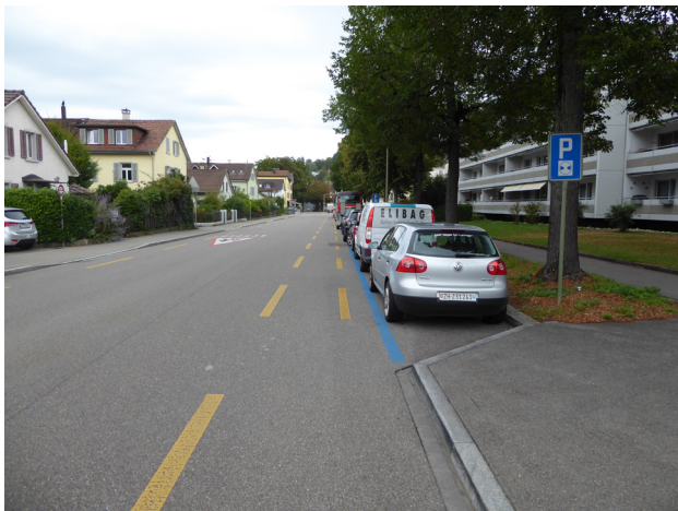
Abbildung 5: Untere Briggerstrasse, nach Einmündung Agnesstrasse Konflikt zwischen Längsparkierung der Blauen Zone und Veloverkehr auf zu schmalen Radstreifen.
