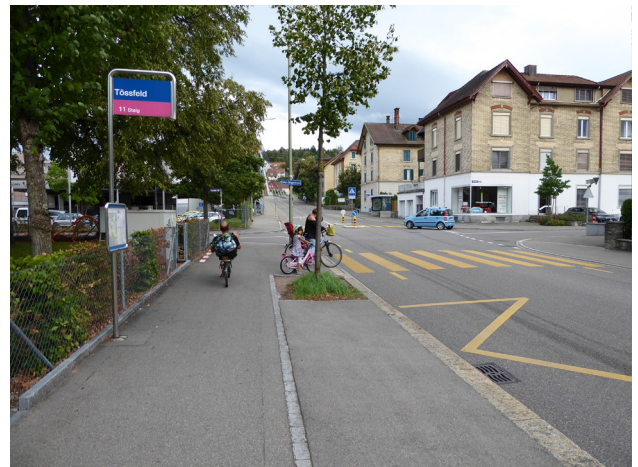
Abbildung 8: Knoten Untere Briggerstrasse / Tössfeldstrasse mit Haltestelle Tössfeld Bei haltendem Bus ist die Sicht zwischen querenden Fussgängern am Schulhaus und Fahrzeugen aus Richtung Zürcherstrasse eingeschränkt. Eine Schutzinsel in Fahrbahnmitte ist nicht vorhanden. Velofahrer nutzen das Trottoir als Verbindung zwischen den Veloabstellanlagen am Schulhaus und der Tössfeldstrasse.
