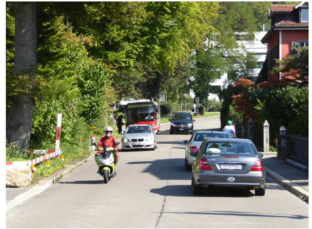
Abbildung 6: Haldenstrasse zw. Brauerstrasse und Albanistrasse Bus hält in überholbarer Fahrbahnhaltestelle Haldengut Richtung Bahnhof. Das Zeichen 4.11 Standort eines Fussgängerstreifens und mögliche Fussgänger befinden sich im Sichtschatten des haltenden Busses.
