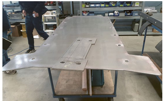
Grundform eines Geländerelements vor der Falzung
