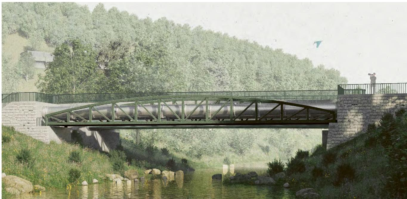
Die neue Rohrbrücke wird parallel zur bestehenden Verkehrsbrücke geführt (Visualisierung: Cristina Rutz Architekten, Winterthur).
