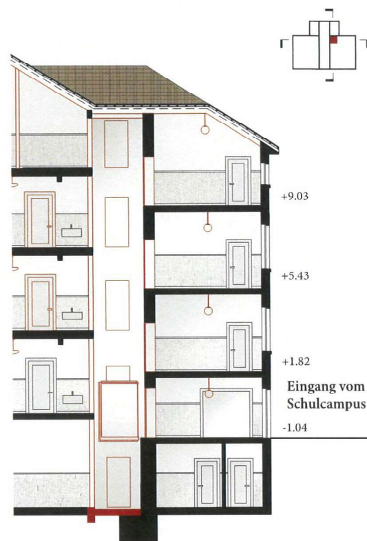
Schnitt mit hindernisfreier Erschliessung der Zwischengeschosse im Risalit
