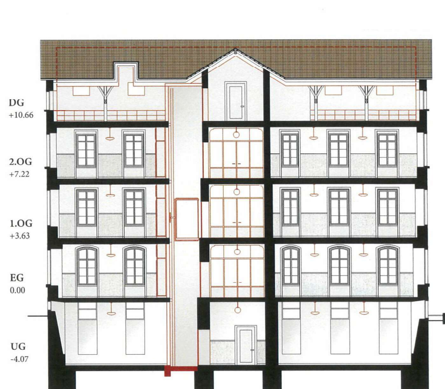
Schnitt mit hindernisfreier Erschliessung Hauptgeschosse und Ansicht Korridorabschlüsse Windfang und Gruppenräume
