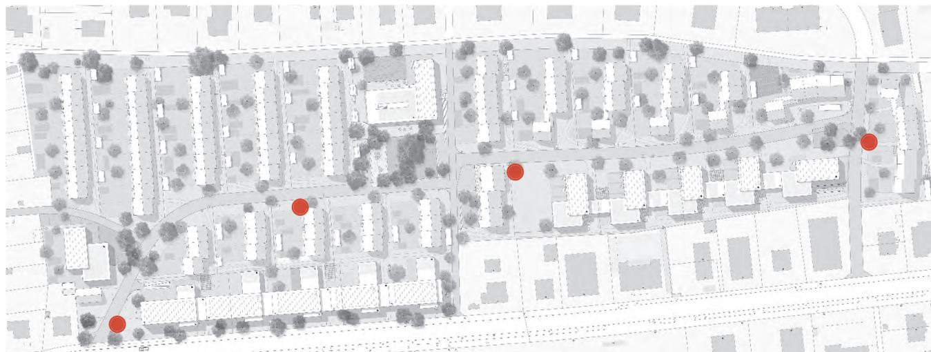
Die roten Punkte zeigen die mögliche Position der Unterflurcontainer an.
