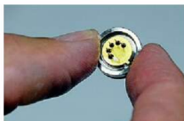
Druckabnehmer mit integrierter Messzelle. Foto: M. Dahinden
