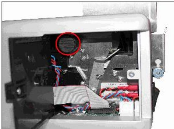
Das Drehen der Einstellschraube bedeutet: *im Uhrzeigersinn => kleinere Kartendicke*
