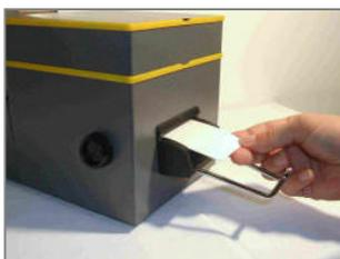
Die Reinigungsroutine wird durchgeführt und die Reinigungs-Chipkarte anschließend wieder ausgeworfen.
