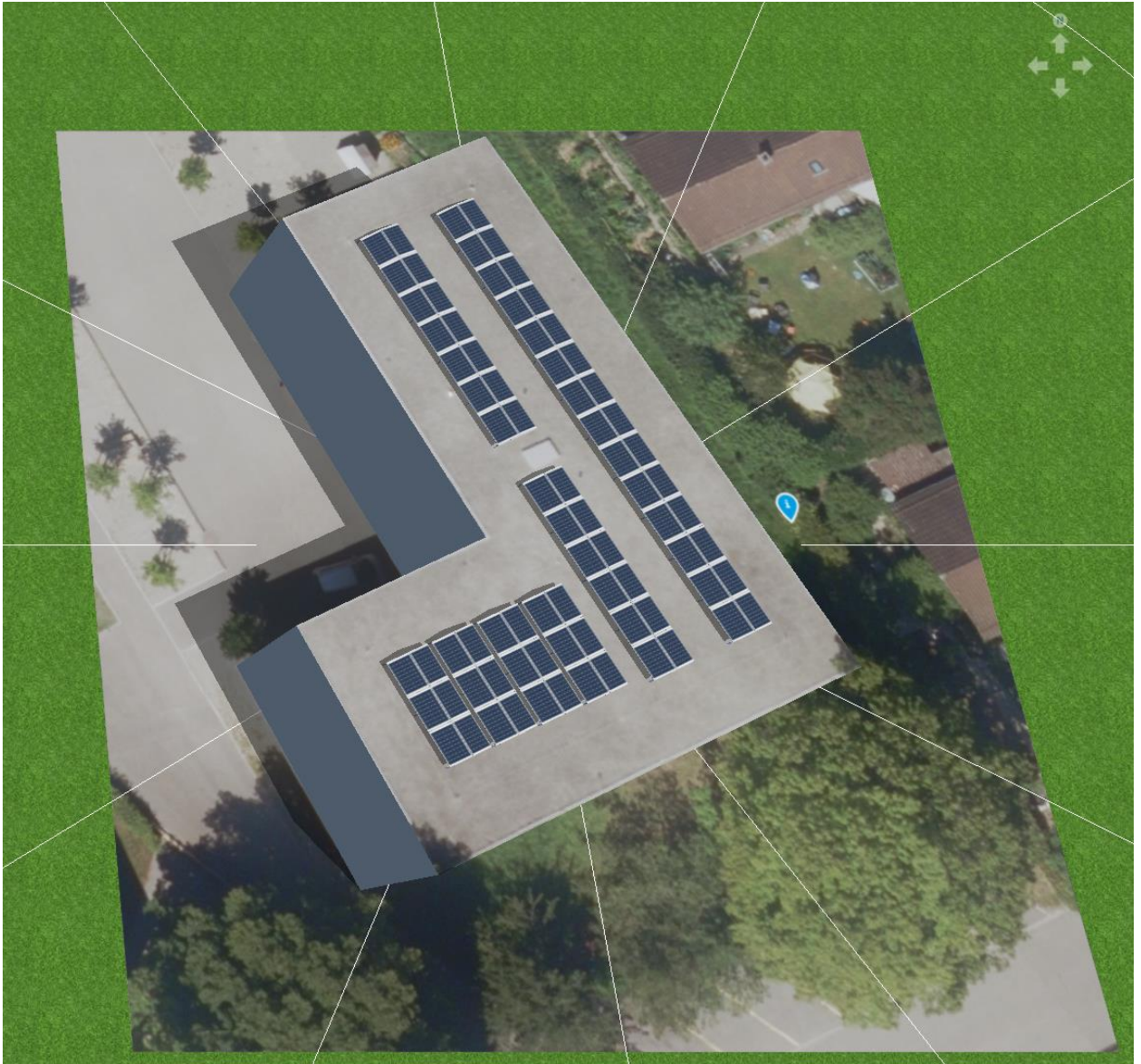
Planung der Belegung für den Modulbau der Schulanlage Schachen
