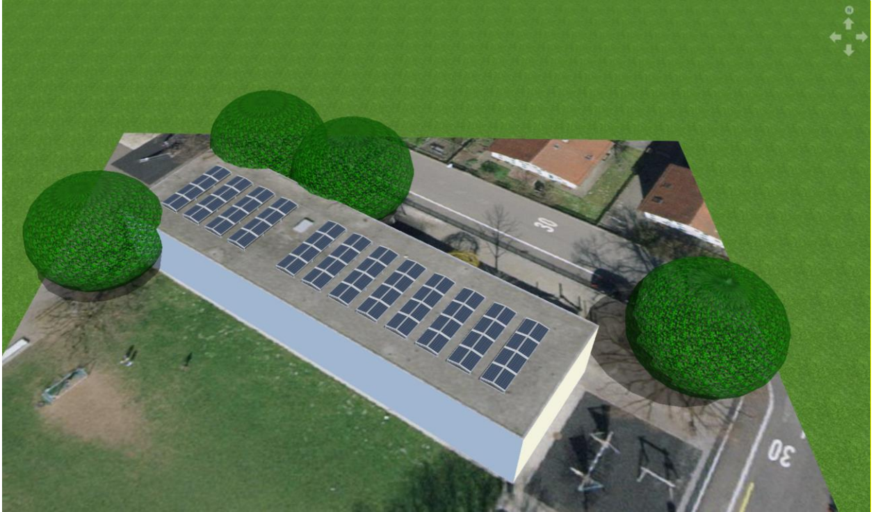
Ansicht Belegung mit Fotovoltaikmodulen Modulbau Schulhaus Eichliacker
