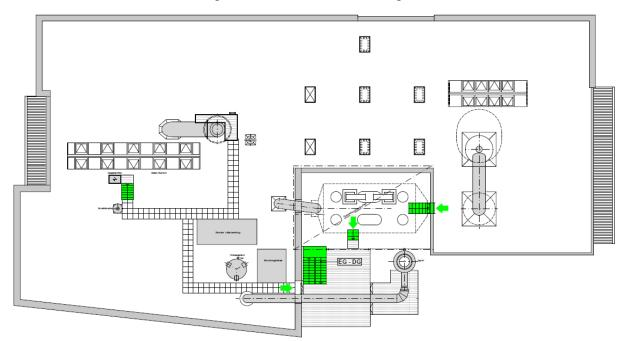
Das Dach der Schlammentwässerung (Schlammverbrennungsanlage) ist zu sanieren, nicht mehr benötigte Aufbauten sind zu entfernen und abzudichten. Zusätzlich werden Vorrichtungen zur Absturzsicherung erstellt.
