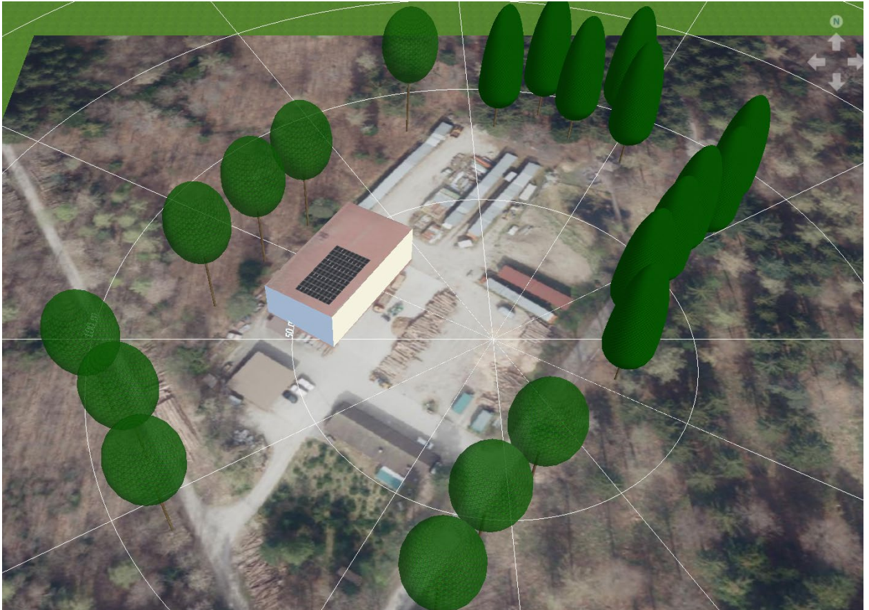
Planung der Belegung für das Dach des Forstwerkshofs Eschenberg – Pilotanlage
