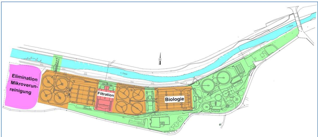
Die braun und rot gefärbten Anlagenbereiche sind zu sanieren und auf den neuen Stand der Technik zu bringen. Die rosa Fläche ist vorgesehen für die neu zu erstellenden bzw. zu ergänzenden Einrichtungen für die Elimination von Mikroverunreinigungen.
