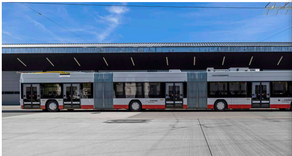
Abb. 44: HESS lighTram, 25 DC (Typ BGGT-N2D) der Carrosserie HESS AG 24.7 Meter lange, Platz für 220 Personen, digitaler Rückspiegel, Tempomat (einstellbar auf 30 und 50 km/h), ökologisch optimierte Heizung
