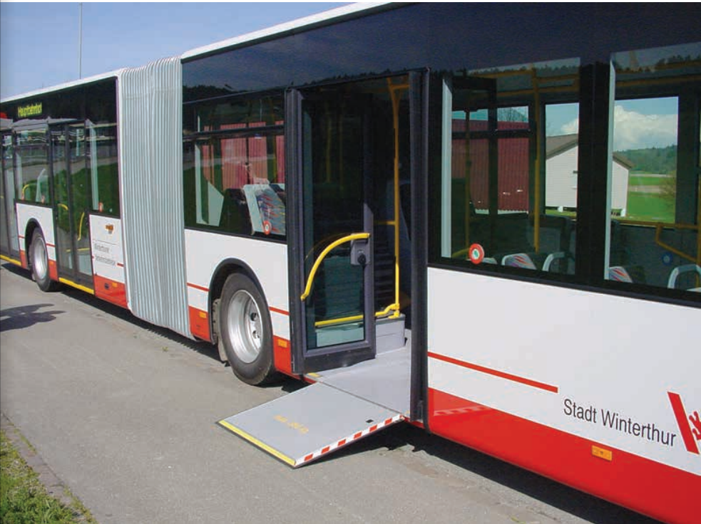
Abb. 17: Ausfahrbare Rollstuhlrampe für barrierefreien Zugang.
