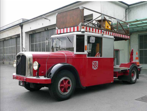
Abb. 23: Von Stadtbus zum Turmwagen umgebauter Saurer, 1931.
