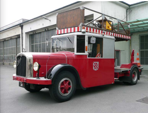
Abb. 23: Von Stadtbus zum Turmwagen umgebauter Saurer, 1931.
