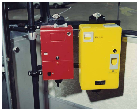
Abb. 10: Mehrfahrtenkartenentwerter (links) und Billettausgabegerät für Einzelfahrten (rechts).
