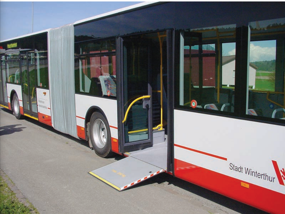
Abb. 17: Ausfahrbare Rollstuhlrampe für barrierefreien Zugang.
