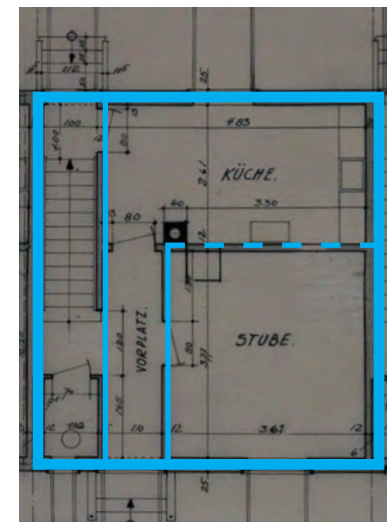
Zu erhaltende Grundstruktur in Ausschnitt bauzeitlicher Plan
