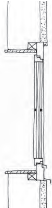
Neues Fenster mit Wärmedämmputz (auch mit Rahmendoppel möglich)
