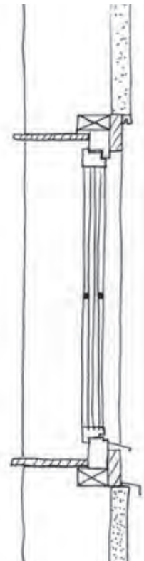
Altes Fenster mit Wärmedämmputz und Rahmendoppel
