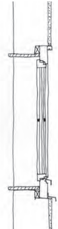
Neues Fenster mit bauzeitlichem Putz
