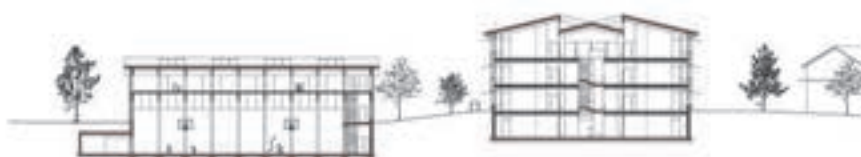
Längsschnitt Sportgebäude, Querschnitt Schulhaus 1:1000
