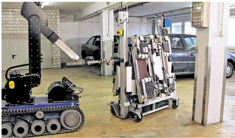
Schutz für das Bombenentschärfungskommando: Mit dem Roboter können Autos aus bis zu einem Kilometer Entfernung weggeschoben werden. pd
