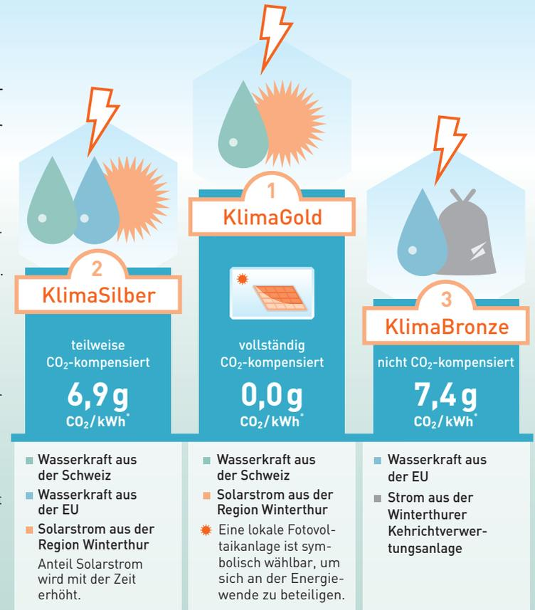
\* Die CO<sub>2</sub>-Belastung wird auf die produzierte Strommenge (Kilowattstunden, kWh) bezogen. Betrachtet wird nicht nur die CO<sub>2</sub>-Belastung durch den Betrieb, sondern durch den ganzen Lebenszyklus der Stromerzeugungsanlage, also inklusive Bau und Entsorgung.
