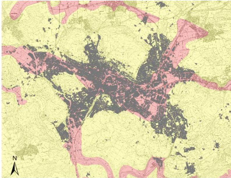
Abb. 14: Erdwärmesondenkarte: rot = Erdwärmesonden nicht erlaubt, gelb = Erdwärmesonden erlaubt<sup>19</sup>
