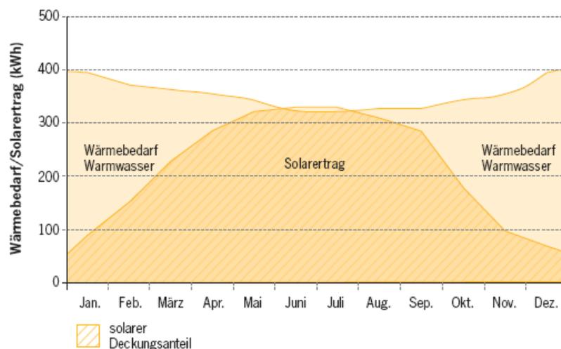
Abb. 16: Wärmebedarf zur Warmwasserbereitung für einen 5-Personenhaushalt und Solarertrag von 5 m<sup>2</sup> Flachkollektoren im Jahresverlauf<sup>21</sup>
