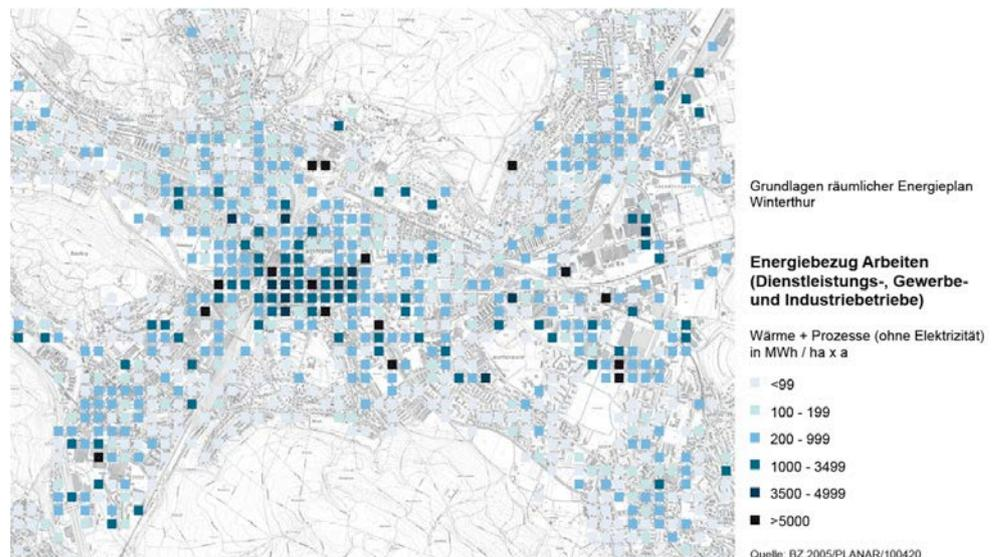
Abb. 3: Wärmebezugsdichte Arbeiten im ha-Raster (Quelle: BZ 2005)
