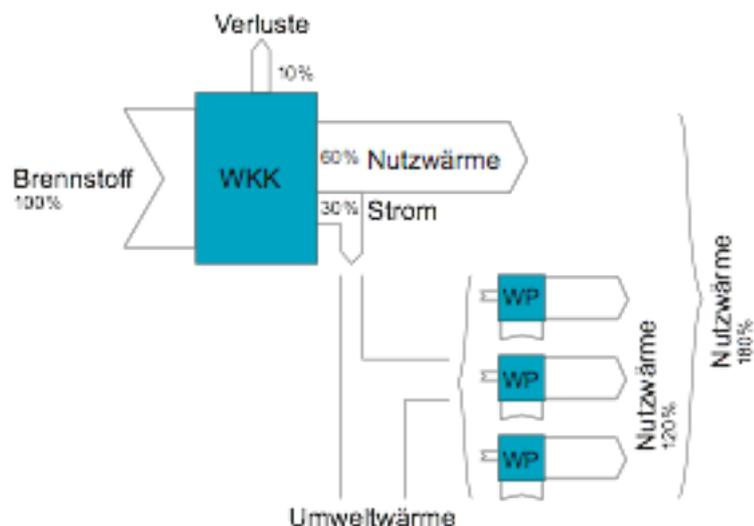
Abb. 17: Prinzipskizze und Nutzungsgrad einer wärmegeführten WKK-Anlage
