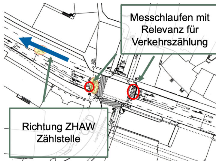
Abbildung 18 Planzeichnung der Messschlaufenanlage bei der Kreuzung Technikumstrasse und Lagerhausstrasse. Annotiert sind die relevanten Messschlaufen für die Validierung und die Richtung zum Standort der ZHAW-Verkehrszählung.
