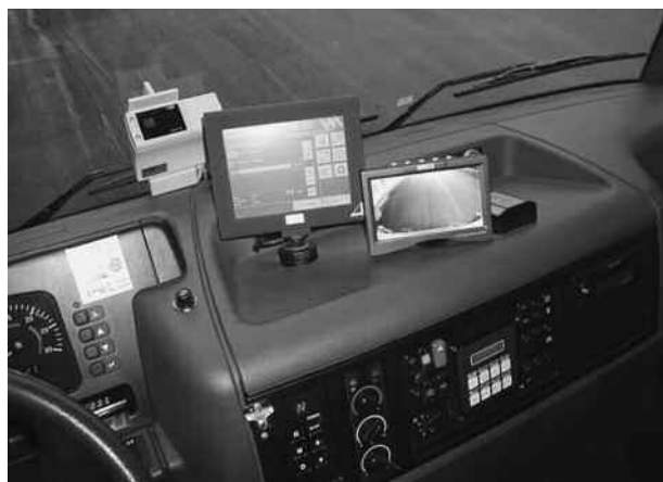
Bordrechnersystem zur Erfassung der Wäge- und Betriebsdaten
