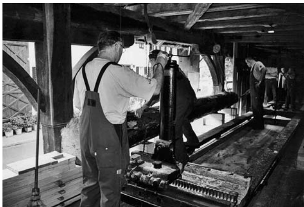
Tag des Denkmals 2005 in Hegi: Der Verein «Säge Reismühle» demonstrierte die Funktion der wasserradbetriebenen Säge am Reismühleweg.
