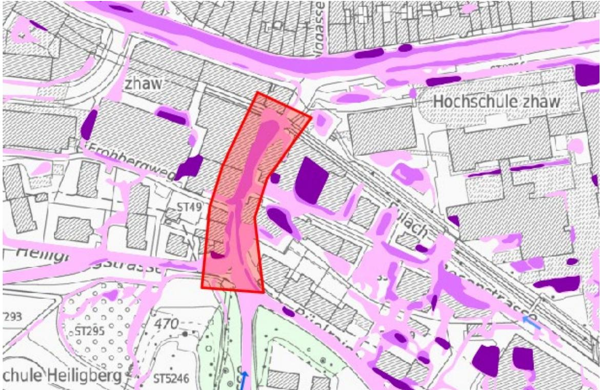
**Abbildung 1: Oberflächenabflusskarte, GIS Kanton Zürich**
