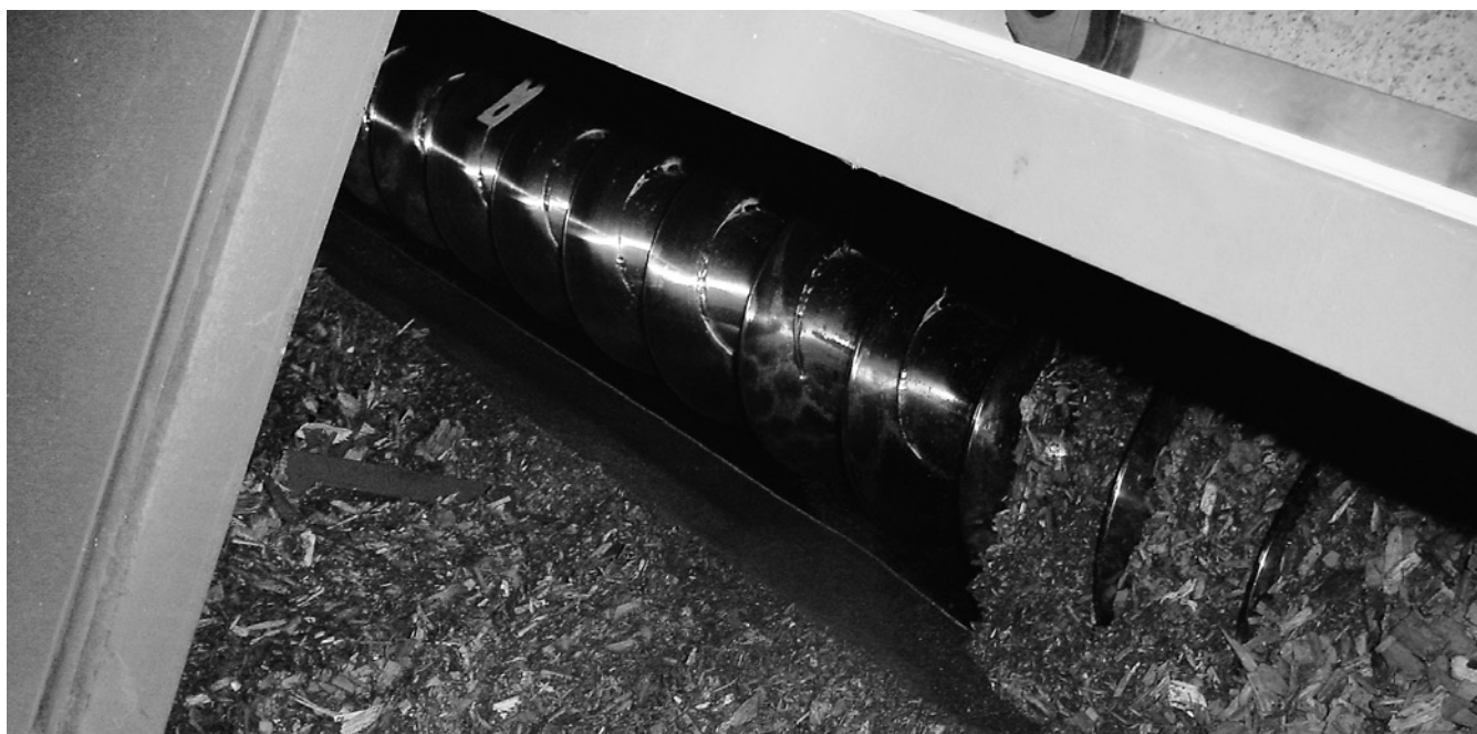
Holzzufuhr mit einer Schnecke in die Holzfeuerung.
