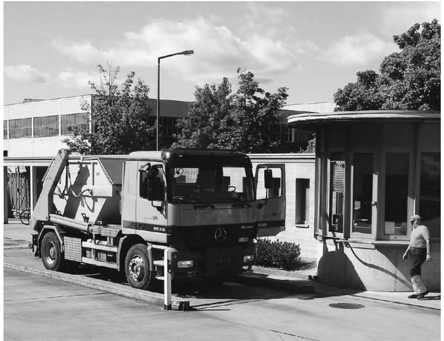
Wägen eines mit einer Wechselmulde beladenen Lastwagens. Die heutige Wägestation wird durch eine Doppelwaage ersetzt, die eine getrennte Bedienung ankommender und wegfahrender Fahrzeuge ermöglicht.
